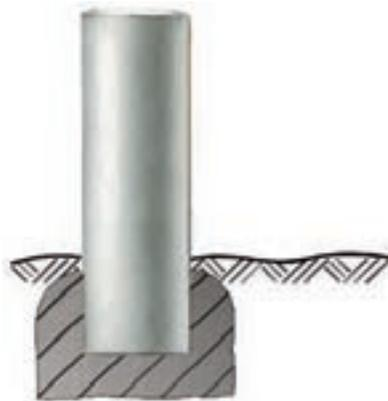
Daraus ergibt sich auch die Tiefe des Fundamentgrabens, wobei Fundamenthöhe (Betonstärke unter den Palisaden) sowie eine Sauberkeitsschicht aus Kies oder ähnlichem zu berücksichtigen sind. Nach dem Aushub des Versetzgrabens wird eine mindestens 10 cm starke Sauberkeitsschicht aus Kies oder ähnlichem Material eingebracht und verdichtet.
